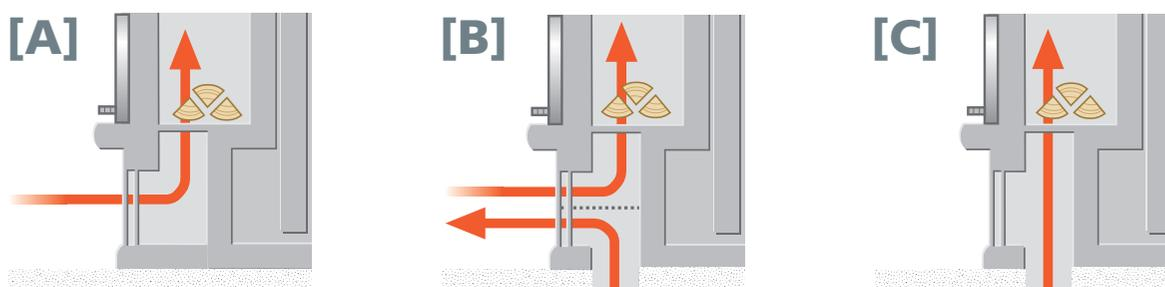
Prima di iniziare ad accendere la stufa, effettuare le seguenti procedure per ogni alternativa di afflusso dell'aria:
