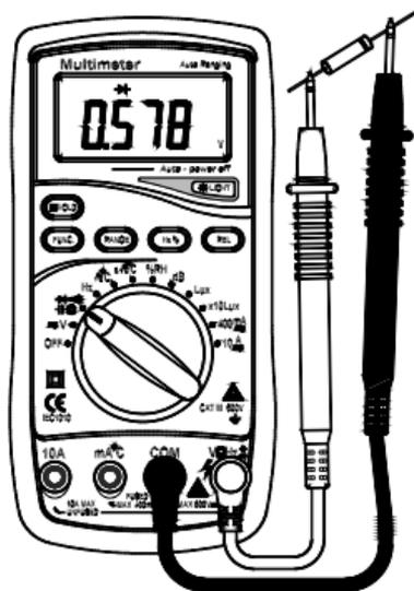
1. Inserire il cavo di prova rosso nella presa  $V\Omega Hz$  e il cavo nero nella presa COM.
