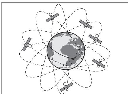
Il sistema GPS si basa sulla ricezione di segnali di navigazione di un insieme di 24 satelliti, che gravitano in orbita attorno alla Terra in 12 ore ad un'altezza di 20 000 km.
