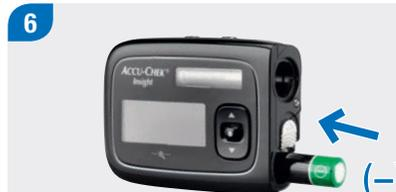
Inserire la nuova batteria nel vano batteria introducendo per primo il lato con il polo positivo; il polo negativo spunta fuori.
