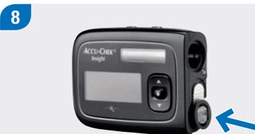
Spingere il copibatteria nel vano batteria finché si sente il clic di completo inserimento.
