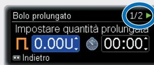
Se le operazioni da compiere fanno parte di una sequenza (procedura guidata), i numeri nell'angolo superiore destro dello schermo indicano quante operazioni sono ancora necessarie.
