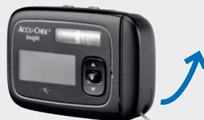
Ruotare l'adattatore in senso antiorario.
