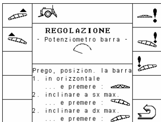
Fig. 5-1: Calibrazione funzione di regolazione parallela a pendio
