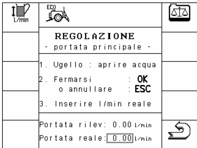
Fig. 4-8: Metodo ugelli, immissione
