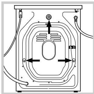
3. Отстранете 3-те винта за предпазване при превода и гумената гарнитура със съответната втулка за раздалечаване, поставени в задната част (виж фигурата).
