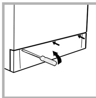
1. свалете панела в предната част на пералната машина с помощта на отвертка (виж фигурата);
