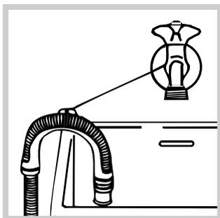
sau sprijiniți-l pe marginea unei chiuvete sau a unei căzi, legând ghidajul aflat în dotare, de robinet (*a se vedea figura*). Extremitatea liberă a furtunului de evacuare nu trebuie să rămână cufundată în apă.
