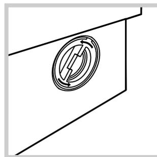
2. deșurubați capacul rotindu-l în sens invers (a se vedea figura): este normal să curgă puțină apă;
