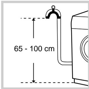
Conectați furtunul de evacuare, fără a-l îndoi, la o conductă de evacuare sau la o gură de evacuare a apei, situate între 65 și 100 cm de pământ;
