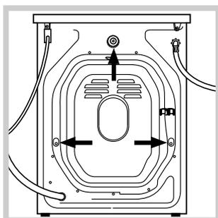
3. Scoateți cele 3 șuruburi de protecție pentru transport și cauciucul cu respectivul distanțator, situate în partea posterioară (a se vedea figura).
