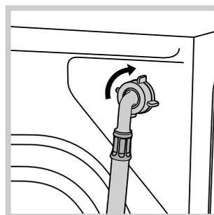
2. Conectați furtunul de alimentare la mașina de spălat, înșurubându-l la respectiva priză de apă, sus, în dreapta (a se vedea figura).
