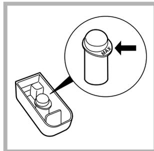
Introduceți sertarul adițional 4, aflat în dotare în sertarul 1. Când dozați decolorantul nu depășiți nivelul „max” indicat pe pivotul central (a se vedea figura).
