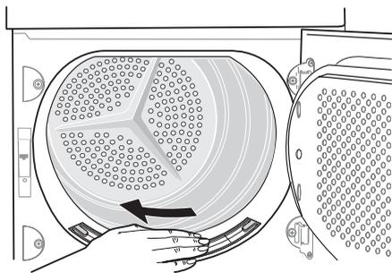
3. Dopo un certo periodo di tempo, sui filtri si deposita una patina composta da residui di detersivi nella biancheria. Quando ciò avviene, pulire i filtri con acqua tiepida e una spazzola. Rimuovere il filtro dalla porta tirandolo. (Può essere posizionato con il nottolino rivolto a destra o a sinistra). Dopo la pulizia, non dimenticare di rimontarlo.
