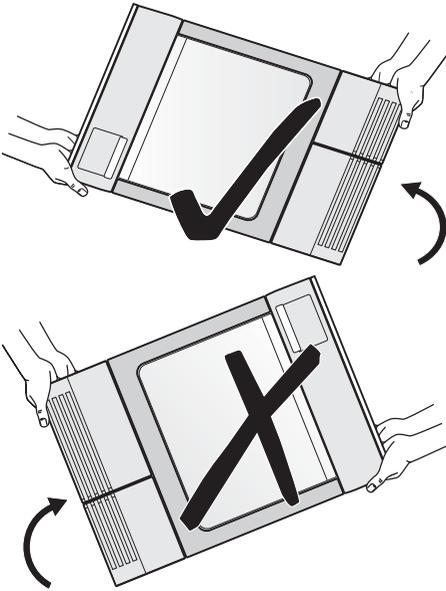
**⚠ Avvertenza** Se l'apparecchio è stato ribaltato durante il trasporto, lasciarlo in posizione verticale per 12 ore prima di connetterlo alla presa elettrica e utilizzarlo per la prima volta, in modo che l'olio possa scorrere nuovamente nel motore. In caso contrario il motore rischia di venire danneggiato.
