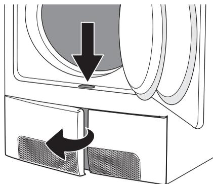
2. Estrarre l'alloggiamento del filtro tramite la maniglia.
