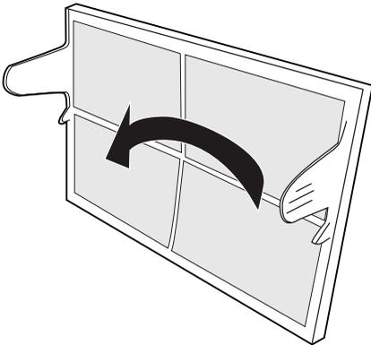
7. Rimontare il filtro nell'alloggiamento.
