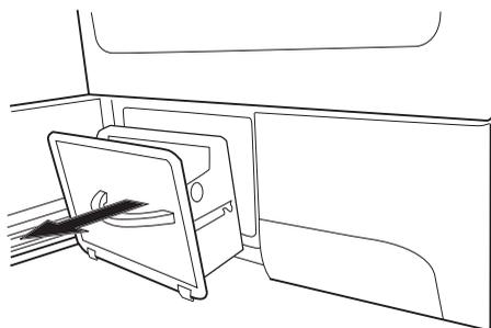
3. Pulire l'interno dello sportello, il vano di raccolta della lanugine e le guarnizioni in gomma.
