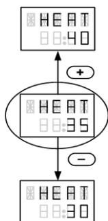
➔ riscaldamento secondo la potenza calorifica impostata manualmente.
