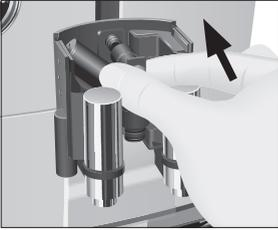
▶ Reinserire i singoli componenti assemblati nell'erogatore combinato e premere finché sono montati saldamente.
