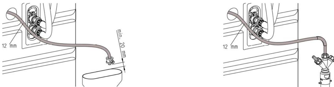
Fig. D-3: Connessione del tubo per il drenaggio per l'acqua di risciacquo con e senza accessori, DN 50, conformemente alla DIN EN 1717, per addolcitori di piccola taglia. (rif. no. 187 840)
