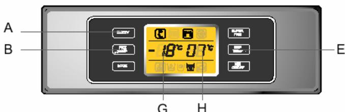
Per impostare la temperatura del vano congelatore: con la modalità Sblocco (la spia sul display è accesa) premere il tasto di controllo della temperatura del vano congelatore (B). La spia della temperatura del congelatore (G) lampeggia. Ogni volta che si preme il tasto di controllo della temperatura del congelatore, compaiono le seguenti temperature: -16°C, -17°C, -18°C, -20°C, -22°C, -16°C.
