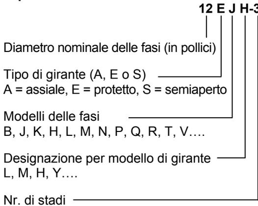
La tipica nomenclatura precedente è una guida generica per la descrizione della configurazione della pompa VTP. Identificare le dimensioni effettive della pompa ed il numero di serie riportati sulla targhetta dati della pompa. Il motore ha una targhetta dati separata fissata su di esso.
