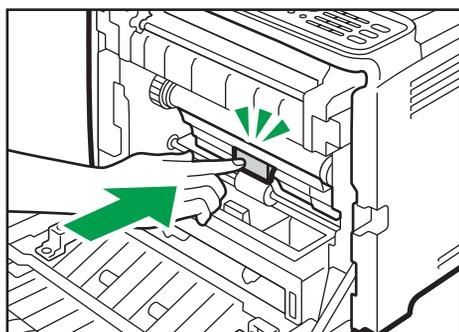
**9. Posizionare l'unità di trasferimento sullo sportello anteriore. Far scorrere l'unità di trasferimento lungo le guide nella macchina.**
