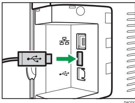
Quando la stampante riconosce la fotocamera digitale come un dispositivo PictBridge, sul pannello di controllo della macchina compaiono i messaggi, "Connessione a PictBridge..." e poi "Pronto".
