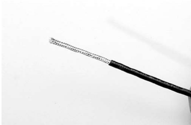
Figura 3.9 – Rimozione guaina in plastica esterna
