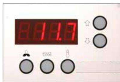
Premere contemporaneamente su “Freccia su” e “Freccia giù” per circa 10 secondi per accedere al menu di esercizio. Sul display viene adesso visualizzata la prima opzione E0 del menu di esercizio. Se nel menu di esercizio non viene premuto un tasto per circa 15 secondi, si chiude automaticamente e l'unità di comando ritorna al menu principale.
