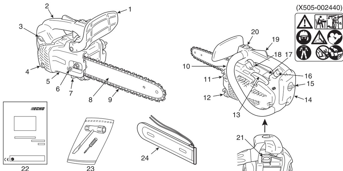
1. **Protezione impugnatura anteriore** - Situata tra l'impugnatura anteriore e la catena della motosega, protegge la mano e consente di controllare la motosega nel caso in cui la mano dovesse scivolare dall'impugnatura. Questa protezione viene utilizzata per attivare il freno che arresta la rotazione della catena.
