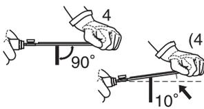
1. Bloccare la catena e spingere in avanti la protezione dell'impugnatura anteriore. Per ruotare la catena, tirare la protezione dell'impugnatura anteriore verso l'impugnatura stessa.
