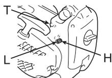
L: Vite di regolazione miscela bassa velocità. H: Vite di regolazione miscela alta velocità.
