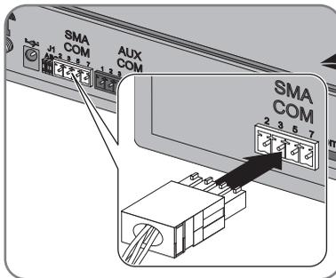
10. Verificare che sull'attacco "SMA COM" di Sunny WebBox siano inseriti i jumper in "J1B" e "J1C". I jumper sono inseriti al momento della consegna. Se così non fosse, inserire i jumper. I jumper servono alla polarizzazione del segnale e garantiscono una qualità sufficientemente buona del segnale del bus di comunicazione RS485.
