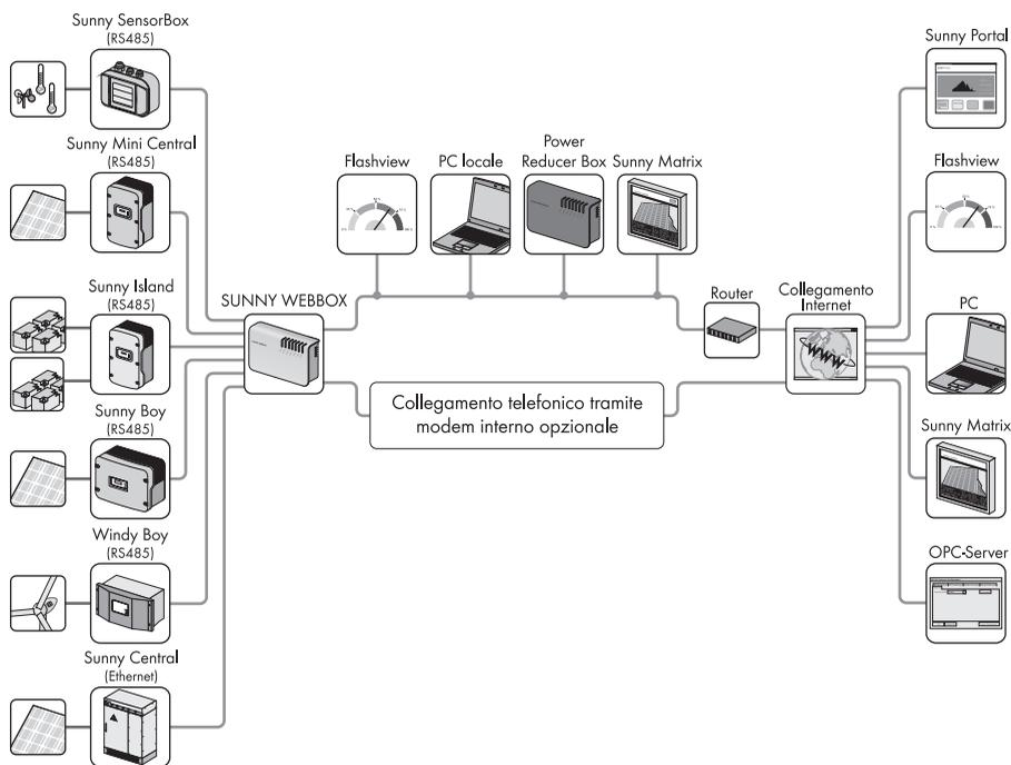
Inoltre Sunny WebBox rappresenta per l'utente uno strumento efficiente per la configurazione dell'impianto e la diagnosi a distanza tramite computer, permettendo un monitoraggio continuo dell'impianto FV e il riconoscimento tempestivo di anomalie di funzionamento. In questo modo Sunny WebBox contribuisce ad ottimizzare i rendimenti dell'impianto.
