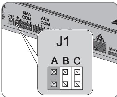
11. A seconda che Sunny WebBox si trovi su una delle due terminazioni del bus di comunicazione RS485, deve essere inserito o meno un jumper in "J1A" sull'attacco "SMA COM". Al momento della consegna il jumper è inserito.
