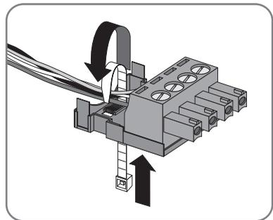
8. Chiudere insieme la parte superiore e quella inferiore della scatola di protezione del cavo con il connettore e premere finché i morsetti non si innestano.
