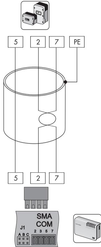
7. Applicare il connettore sulla metà inferiore della scatola di protezione del cavo e fissarvi sopra la guaina del cavo con la fascetta.
