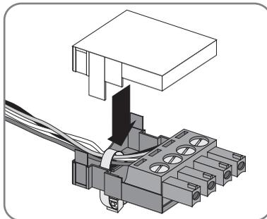
9. Inserire il connettore nell'attacco "SMA COM" di Sunny WebBox.
