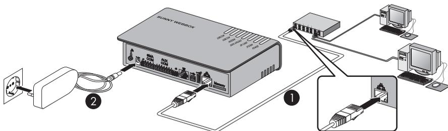
3. Collegare Sunny WebBox con il cavo di rete **rosso** (cavo Patch) direttamente all'utenza dall'altra parte (per es. router, switch o hub) della rete locale (vedere ①). Il collegamento all'utenza dall'altra parte è contrassegnato in linea di massima con lo stesso simbolo riportato sul collegamento rete di Sunny WebBox. Consultare, se necessario, la guida dell'elemento in questione.
