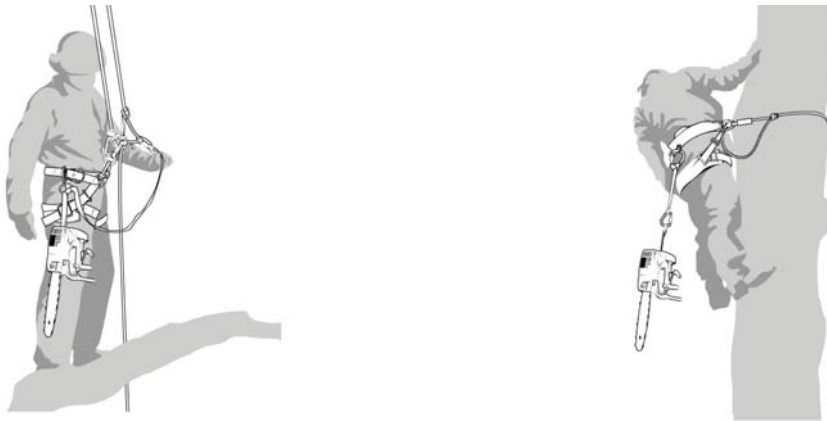
Fig. 3 – Esempi di attacchi della motosega all'imbracatura dell'operatore (tratti dalla norma ISO 11681-2:2006)
