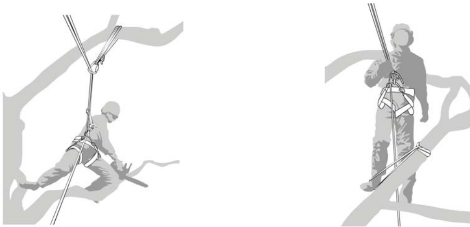
Fig. 4 – Esempi di uso di funi e ganci per assicurare una posizione sicura (tratti dalla norma ISO 11681-2:2006)
