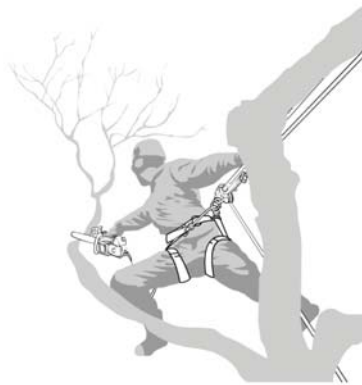
Fig. 2 – Caso di uso della motosega con una sola mano (tratto dalla norma ISO 11681-2:2006)
