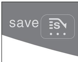
I: Se la spia luminosa SAVE si accende, la stufa si accende e si spegne automaticamente, per rimanere entro una determinata temperatura.
