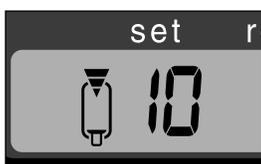
J: Quando appare la spia FUEL, verranno mostrati sul display informativo i minuti di funzionamento che ancora rimangono alla stufa in base alla quantità di combustibile rimasta nel serbatoio.
