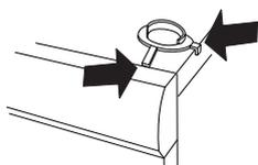
6. Spingere in fuori il foro pretagliato sul retro dell'asciugatrice (aprirlo soltanto, senza rimuoverlo) utilizzando un cacciavite e un martello.
