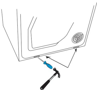
7. Spingere l'asciugatrice sotto le staffe in metallo. Contemporaneamente, tenere sollevato il bordo anteriore di 10mm - 20mm.
