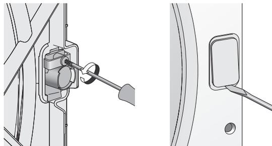
8. Fissare nuovamente la parte interna dello sportello con le viti (13 in totale).
