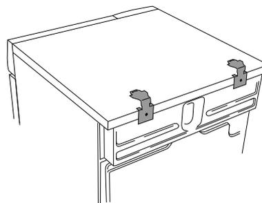
4. Inserire le coppette in plastica per fissare i piedini anteriori dell'asciugatrice al coperchio superiore della lavatrice. Questo passaggio è essenziale, dato che solo quando i piedini dell'asciugatrice si trovano nelle coppette in plastica si può essere certi che l'asciugatrice sia posizionata correttamente sulla lavatrice.
