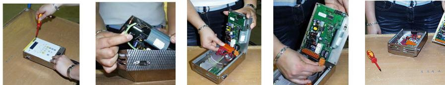
Fig. 25: Sostituzione di un controller
