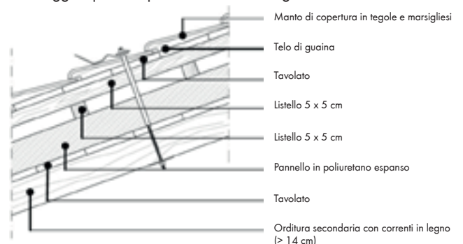
Montaggio tipo su copertura ventilata in legno
