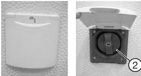
Bocchettone di rifornimento per il serbatoio acqua pulita
