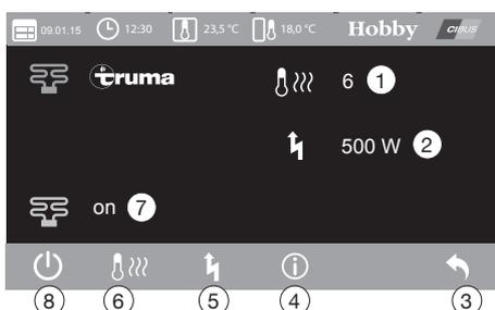
Menù del riscaldamento supplementare a funzionamento elettrico sul display TFT
