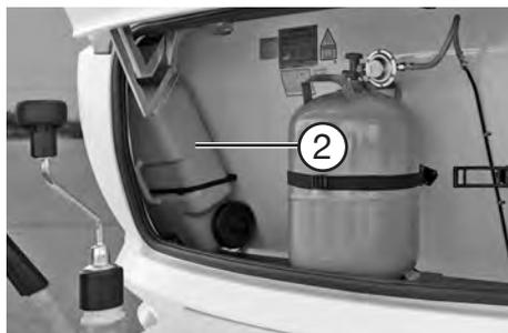
Serbatoio dell'acqua di scarico nel vano porta bombole di gas
