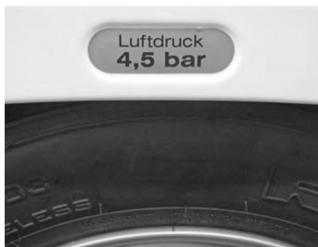
Adesivo di segnalazione della pressione dell'aria del pneumatico
