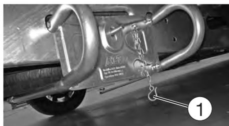
Sicura delle viti in corrispondenza del fissaggio porta ruota di scorta
