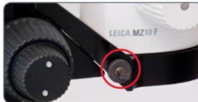
2. Fissare il supporto per la protezione antiabbagliamento UV con un lato all'adattatore. L'altro lato tiene la protezione antiabbagliamento.
