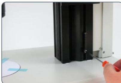
3. Spingere la battuta di fine corsa all'altezza della messa a fuoco motorizzata.
