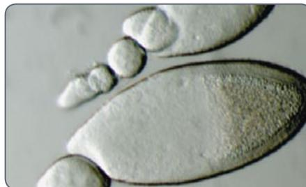
Si può ottenere un incremento del contrasto senza rilievo quando entrambi i diaframmi sono posizionati a 45°. Si genera così una fessura luminosa. Grazie al ribaltamento fine dello specchio di rimando è possibile spostare la fessura sull'intera superficie del campo visivo e passare velocemente dalla rappresentazione a rilievo positivo a quella a rilievo negativo. L'effetto dinamico permette di differenziare con semplicità strutture di fase da strutture di ampiezza.
