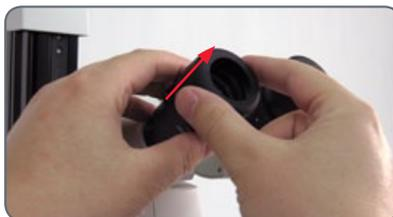
2. Nel caso in cui l'oculare sia dotato di correzione diottrica integrata, ruotare il valore sul contrassegno "0".
