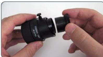
4. Ora è possibile allineare il reticolo ruotando l'oculare nel tubo e poi fissarlo con la vite di fissaggio.
