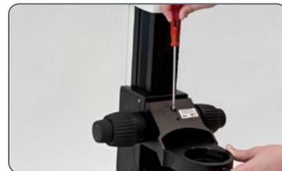
3. Collocare il tubo nel supporto del microscopio e fissarlo con la vite di blocco.
