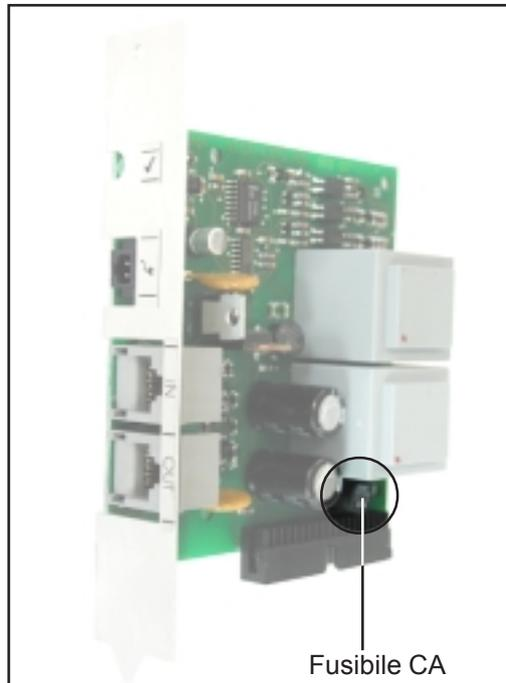
Le COM Card provvedono all'alimentazione dei componenti DatCom. L'alimentatore integrato di una COM Card di questo tipo riceve l'alimentazione nello slot mediante contatti speciali che conducono la tensione di rete anche quando l'alimentazione di rete non funziona.
