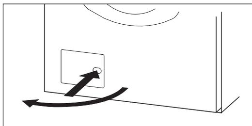
3. Faites sortir le tuyau de vidange, retirez-en le bouchon de fermeture, laissez l'eau s'écouler dans un récipient. Répétez éventuellement l'opération plusieurs fois.
