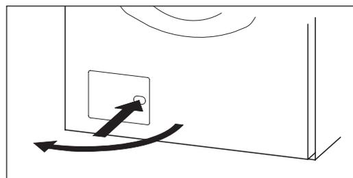
3. Estrarre il tubo di svuotamento, estrarre il tappo di chiusura, lasciar scorrere l'acqua in un contenitore. Se necessario, ripetere più volte l'operazione.
