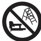
Secondo la norma europea EN 792-13, il regolamento vale del 1. 1.2001 che tutti apparecchi per chiodatura muniti di scatto a contatto devono essere contrassegnati con il simbolo „Non utilizzare da impalcature o scale a pioli” e non devono essere utilizzati per utilizzi certi, per esempio:
