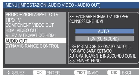
**AUTO** Selezionare questa opzione se all'interfaccia **HDMI OUT** è collegato un apparecchio con decodificatore multicanale integrato, ad esempio Dolby Digital.
