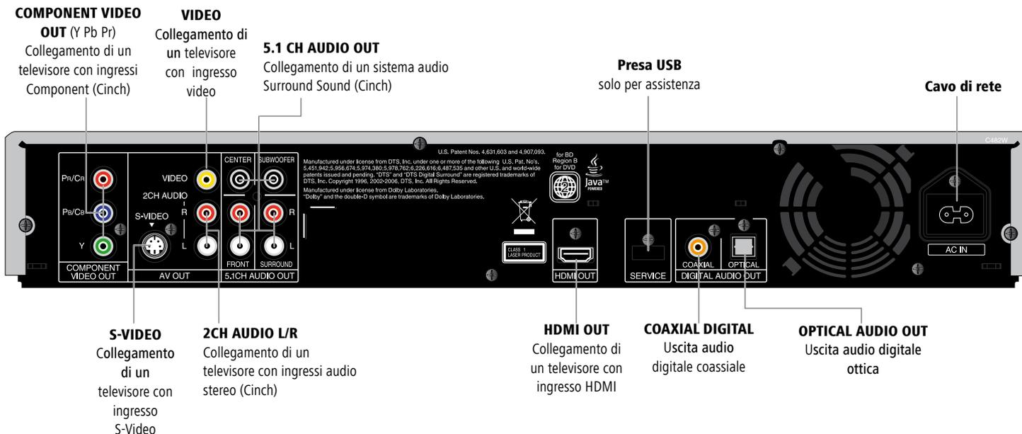
**Attenzione: non toccare i perni interni delle prese di collegamento della parte posteriore dell'involucro. Eventuali scarica elettrostatiche possono causare danni permanenti all'apparecchio.**
