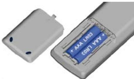
Per inserire o cambiare le batterie, premere sul punto dove è impressa la freccia. Contemporaneamente, far scorrere il coperchio del vano batterie verso il basso e rimuoverlo. Inserire le batterie del tipo Alcali/Manganese LR 03 (AAA), facendo attenzione alla corretta posizione dei simboli + e -. Infine, reinserire il coperchio dal basso.
