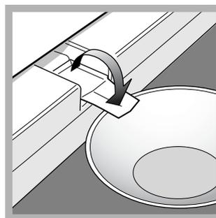
5. Alcuni apparecchi sono dotati del SISTEMA DRAIN per convogliare l'acqua all'esterno: inserire il raschietto in dotazione nell'apposita fessura posta in basso e lasciare che l'acqua defluisca in un contenitore (*vedi figura*)
