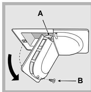
Accedere alla lampada (A) svitando la vite di fissaggio (B) posizionata nella parte posteriore del comprilampada, come indicato (*vedi figura*). Sostituirla con una analoga, di potenza non superiore a 15 W.
