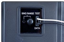
Inserire il cavo adattatore nella presa DATA sul retro della trasmittente, come mostra il disegno. Il sistema di collegamento è protetto contro l'inversione di polarità, fare attenzione alle piccole fasi laterali. Non esercitare mai una forza eccessiva, lo spinotto dovrebbe inserirsi facilmente.
