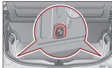
Fig. 37 Bagagliaio: Occhielli di ancoraggio
