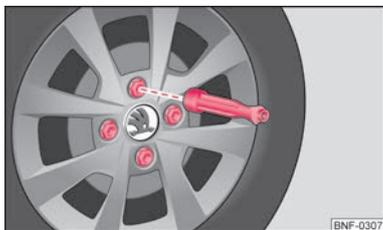
Fig. 105 Sostituzione di una ruota: Allentare i bulloni ruota con l'impugnatura del cacciavite
