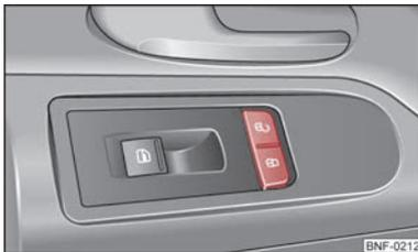
Fig. 12 Tasto per la chiusura centralizzata
