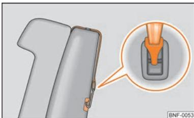
Fig. 84 Cintura di fissaggio integrata
