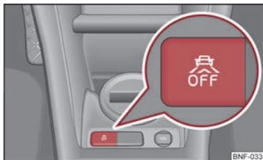
Fig. 66 Parte inferiore della consolle centrale: Tasto per il sistema City Safe Drive.
