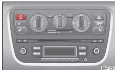
Fig. 64 Tasto per il sistema START-STOP
