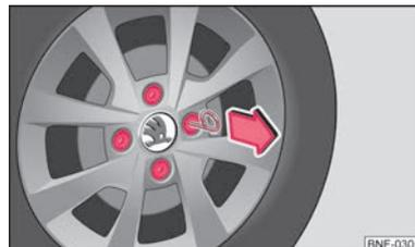
Fig. 103 Cappucci dei bulloni ruota
