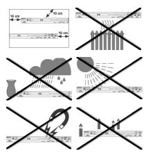
Posizionare l'apparecchio su una superficie piana e stabile. L'impianto non è concepito per funzionare in ambienti con un elevato tasso di umidità (ad esempio in bagno). Assicurarsi che
