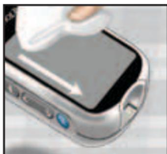
Prima di strofinare lo strumento, accertarsi di avere espulso ogni residuo di liquido in eccesso. Strofinare esternamente il cappuccio.
