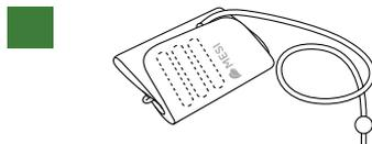
Posizionare il bracciale sul stinco destro. Deve essere visibile la scritta **MEDIAL ANKLE** in forma di freccetta all'interno della caviglia. Il tubo del bracciale va orientato verso il ginocchio.
