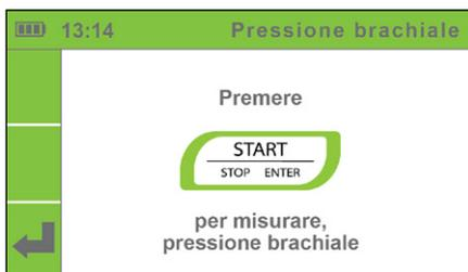
Per effettuare la misurazione premere il pulsante START<sup>(0)</sup>. Durante la misurazione sullo schermo compare la pressione momentanea al bracciale e si delinea lo schema di oscillazione della pressione. Sulla parte sinistra dello schermo compare una colonna con indicato il tempo di misurazione rimanente.
