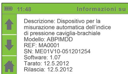
Sono disponibili dati sull'apparecchio (descrizione, modello, REF, SN), informazioni sul software (programmi), data dell'ultima calibratura dell'apparecchio e data della costruzione dell'apparecchio, che indica la data di produzione.
