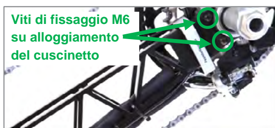
Figura 6: Viti di fissaggio M6 sull'alloggiamento del cuscinetto
