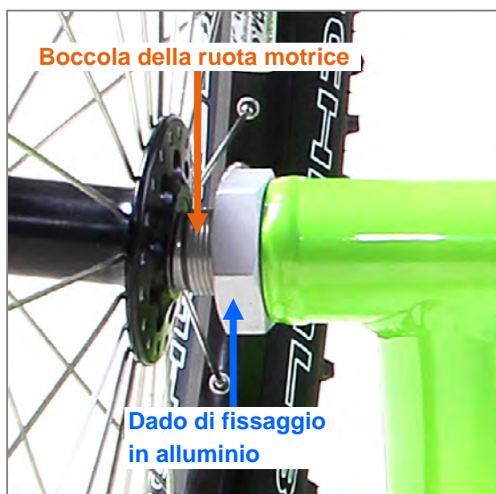
Figura 51: Boccola della ruota motrice e dado di fissaggio in alluminio, vista prodotto da dietro
