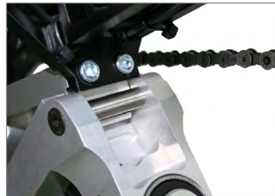
Figura 57: La bocca di aggancio dell'unità motrice scivola sotto l'albero di aggancio sullo chassis
