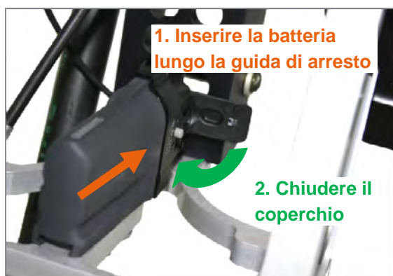
Figura 23: Dopo la ricarica collegare nuovamente la batteria
