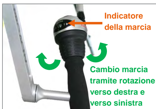
Figura 16: Cambio tramite impugnatura girevole con cambio a mozzo Shimano Nexus Inter8
