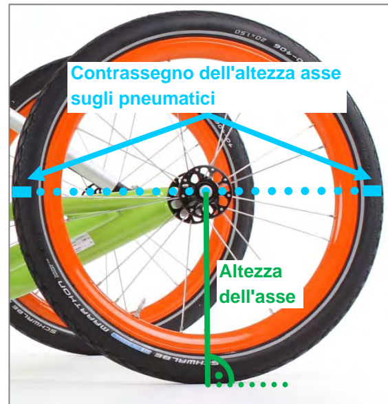
Figura 49: Contrassegno dell'altezza asse anteriormente e posteriormente su entrambi gli pneumatici delle ruote
