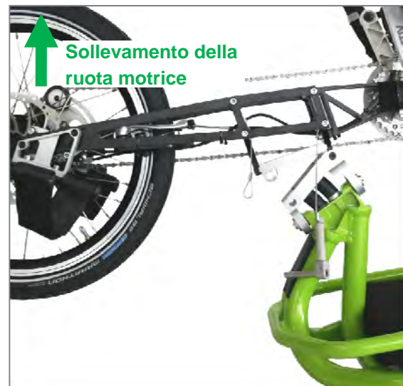
Figura 56: Sollevamento della ruota motrice
