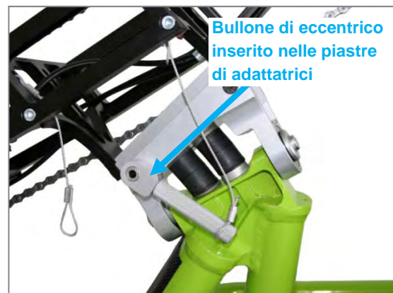
Figura 60: Bullone di eccentrico inserito
