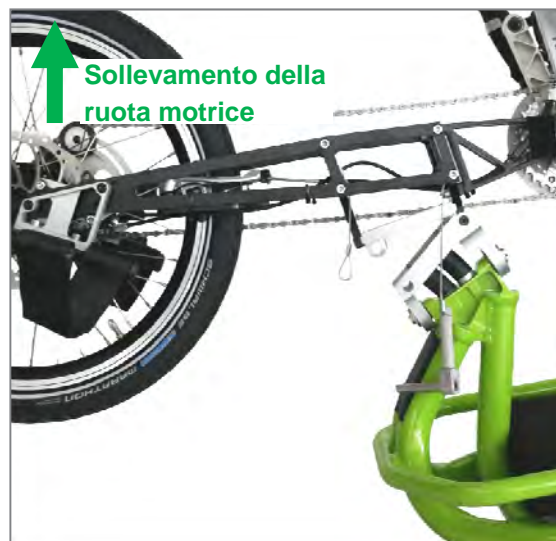
Figura 64: Sollevamento della ruota motrice
