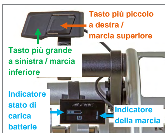
Figura 19: Cambio tramite tasti elettrici con cambio a mozzo Shimano Alfine Di2
