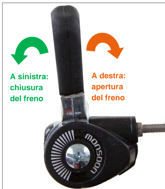
Figura 29: Freno di stazionamento comandabile tramite leva di comando (aperto)
