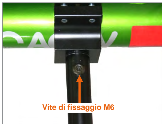
Figura 43: Viti di fissaggio M6 sui morsetti di serraggio sul tubo asse
