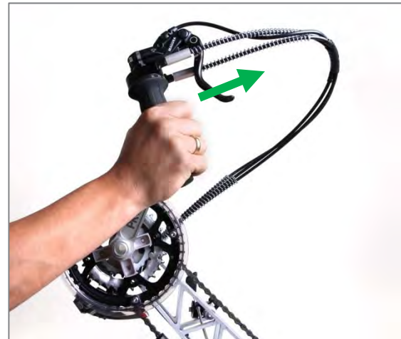
Figura 10: Corretto posizionamento dell'impugnatura con cambio a mozzo Rohloff
