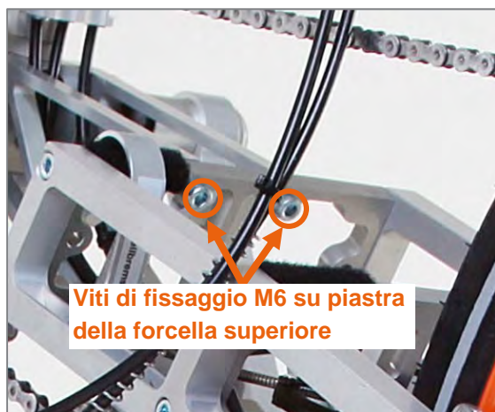
Figura 5: Viti di fissaggio M6 su piastra della forcella superiore
