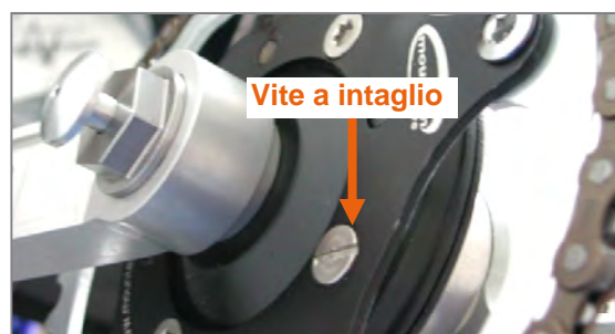
Figura 25: Vite a intaglio da ingrassare
