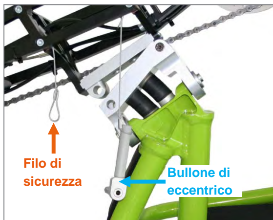
Figura 58: Bocca di aggancio dell'unità motrice sull'albero di aggancio sullo chassis, bullone di eccentrico non ancora inserito
