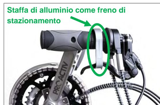
Figura 28: Staffa di alluminio come freno di stazionamento
