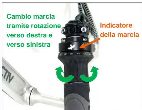
Figura 15: Cambio tramite impugnatura girevole con cambio a mozzo Rohloff a 14 marce Speedhub 500/14
