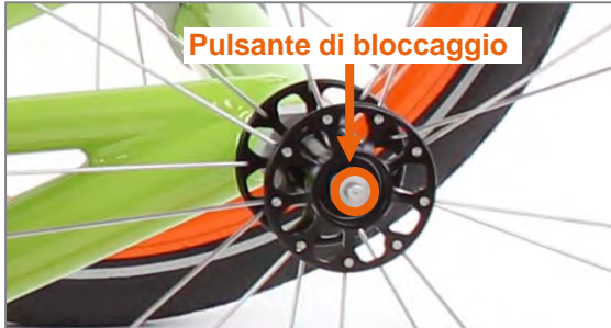
Figura 47: Pulsante di bloccaggio al centro dell'asse ruota
