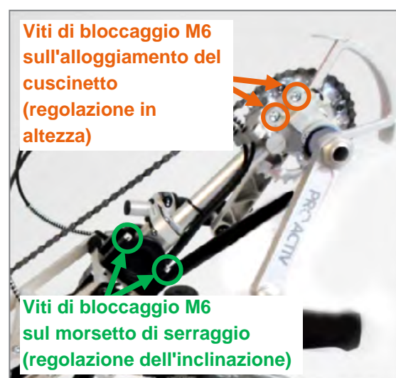
Figura 7: Viti di bloccaggio M6 per la regolazione dell'inclinazione e dell'altezza della posizione del cuscinetto
