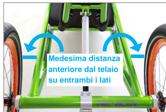
Figura 52: Distanza anteriore dal telaio
