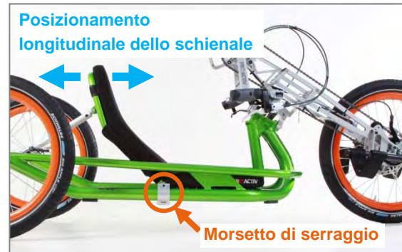
Figura 34: Morsetto di serraggio per il posizionamento longitudinale dello schienale
