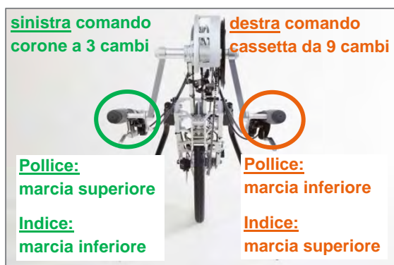
Figura 13: Cambio tramite dispositivi di commutazione pollice-indice
