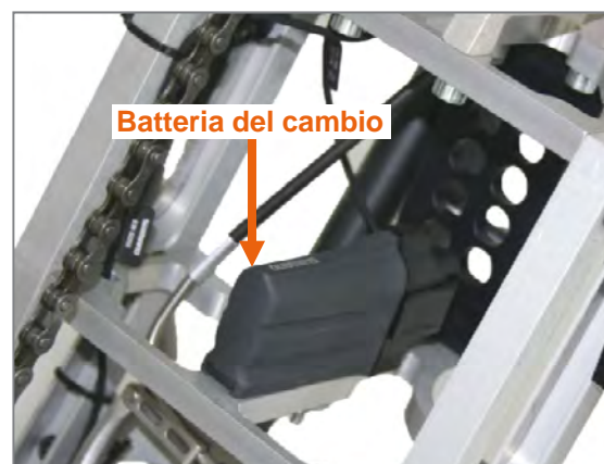
Figura 20: Batteria del cambio elettrico Alfine Di2
