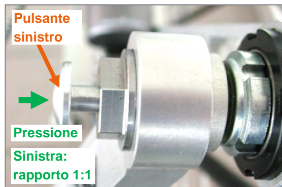
Figura 24: Pulsante sinistro del cambio anteriore integrato
