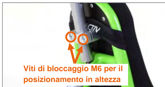
Figura 38: Regolazione in altezza del supporto nuca tramite due viti di bloccaggio M6 sul tubo di supporto del supporto nuca
