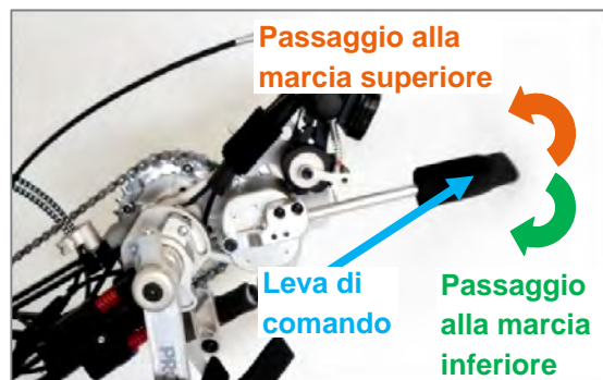
Figura 17: Cambio tramite il comando automatico PROACTIV con cambio a mozzo Shimano Nexus Inter8
