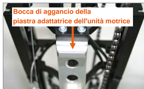
Figura 55: Bocca di aggancio della piastra adattatrice dell'unità motrice
