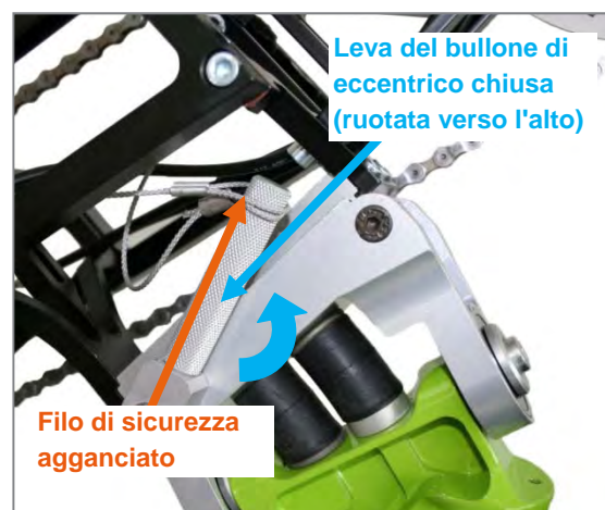
Figura 61: Unità motrice completamente adattata
