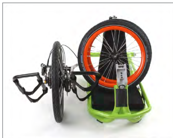
Figura 65: Ingombro: chassis e unità motrice separate e ruote rimosse
