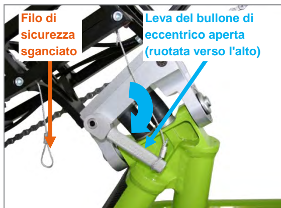
Figura 62: Leva del bullone di eccentrico aperta e filo di sicurezza sganciato
