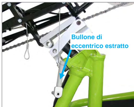
Figura 63: Bullone di eccentrico estratto dalle piastre adattatrici, chassis abbassato sul pavimento
