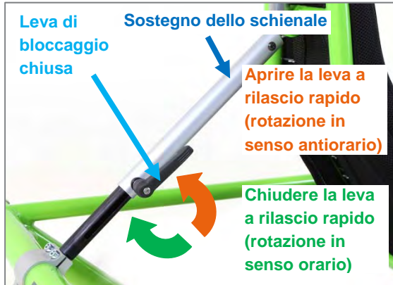
Figura 32: Regolazione dell'inclinazione dello schienale tramite leva di bloccaggio
