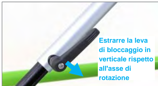
Figura 33: Tramite estrazione portare la leva di bloccaggio in un'altra posizione angolare
