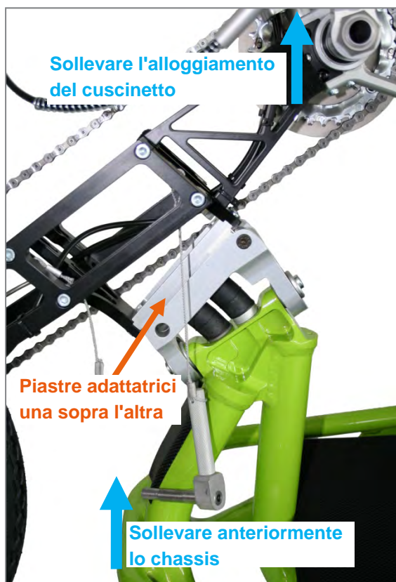
Figura 59: Piastre adattatrici di unità motrice e chassis una sopra l'altra
