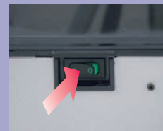
Premere i tasti contemporaneamente. Mantenendo i tasti premuti accendere la macchina.
