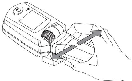
L'elettronica integrata nella maniglia registra i movimenti che partono dalla mano del personale che espleta il comando. Un leggero spostamento della leva verso sinistra o verso destra è convertito in un comando di marcia delle ruote e-fix, di modo che le curve possano venir percorse senza grande dispendio di forze.
