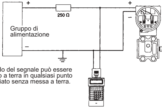
Fig. 1.5 - Collegamenti elettrici per funzionamento del LD301 come trasmettitore.
