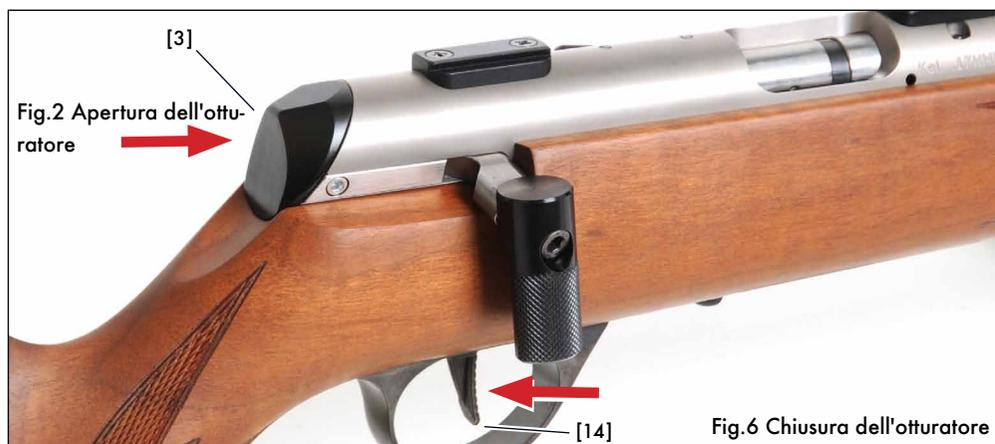
Fig.2 Apertura dell'otturatore
