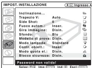
**4** Spegnerne l'alimentazione principale e scollegare il cavo di alimentazione c.a. Il blocco di sicurezza è attivo e diventa efficace. Alla successiva accensione dell'alimentazione viene visualizzata la schermata di immissione della password.
