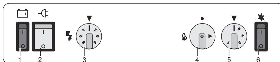
Fig. 90 Elementi di comando del frigorifero (accensione elettrica)
