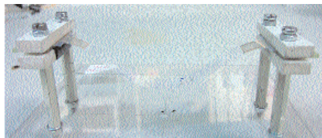
Figura 4 – Prototipo di un dispositivo bistabile in PET. Gli estensimetri stampati in tecnologia inkjet sono utilizzati per lo studio del comportamento dinamico del sistema
