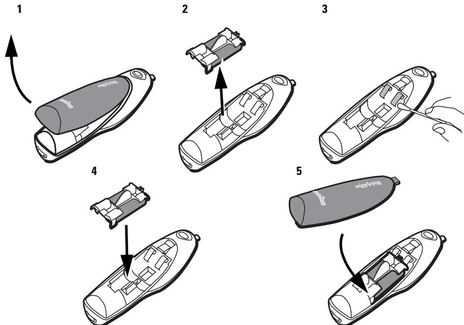
4. Inserire le batterie nuove verificando che i poli siano orientati correttamente.
