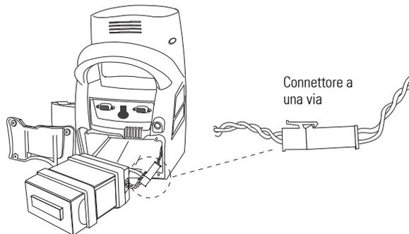
4. Far scivolare la batteria all'interno del comparto fino in fondo. Premere il connettore nel vano accanto alla batteria.
