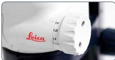
5. Osservare il campione attraverso gli oculari e metterlo a fuoco con il dispositivo di messa a fuoco.
