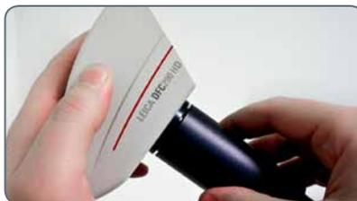
3. Collocare tale gruppo nell'uscita video/foto dello stereomicroscopio e avvitarlo.
