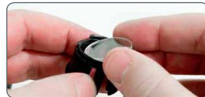
4. Inserire nuovamente l'inserto nell'oculare e premerlo a fondo.
