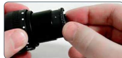
5. Inserire l'oculare nel tubo e, ruotandolo, orientare il reticolo di misura.
