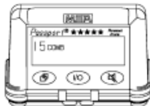
Fig. 1-40 Esempio lettura di gas combustibile
