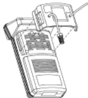
Fig. 1-28 Installazione cappuccio di taratura a scatto
