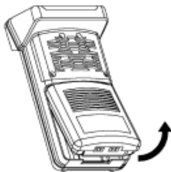
Fig. 1-1 Installazione Pacco Batteria
