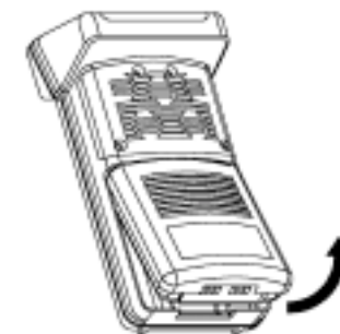
Fig. 1-45 Rimozione Pacco Batteria
