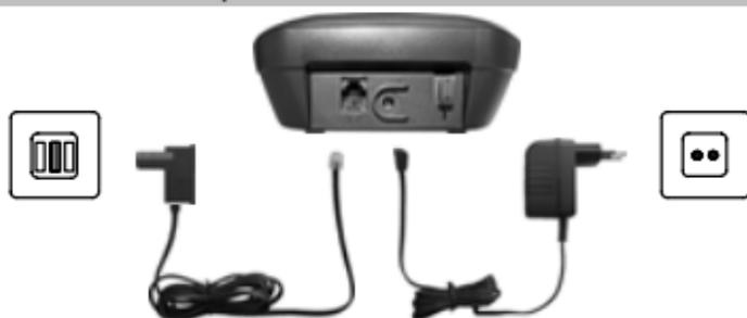
Procedere al collegamento dell'unità base seguendo quanto raffigurato nella figura. Utilizzare per motivi di sicurezza solo l'alimentatore di rete oltre al cavo di collegamento telefonico fornito in dotazione.
