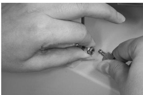
Fig. 18. Scollegamento della linea di alimentazione dell'argon
