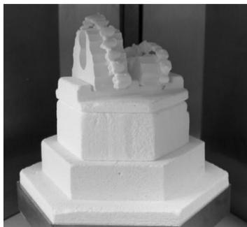
Fig. 26. Posizionamento di ponti con barra di sinterizzazione > 8 elementi
