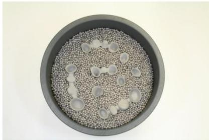
Fig. 15. Posizionamento degli oggetti da sinterizzare
