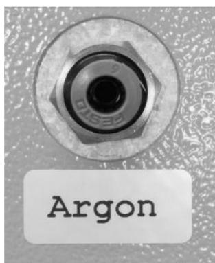
Fig. 9. Connessione per l'argon
