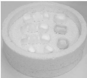
Fig. 24. Posizionamento degli oggetti da sinterizzare
