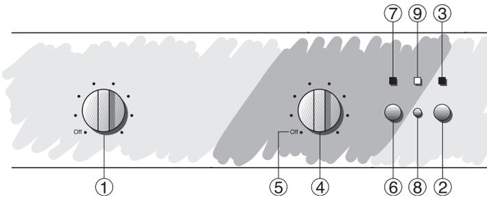
1. Manopola di regolazione del comparto frigo con posizione di spegnimento del comparto stesso.
