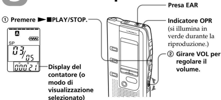
Al termine della riproduzione di un messaggio, l'apparecchio si ferma all'inizio del messaggio successivo.
