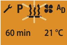
Indicazione per i riscaldatori ad aria in modalità di riscaldamento continuo
