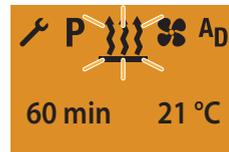
Indicazione per i riscaldatori ad aria in modalità di riscaldamento continuo (impostazione di fabbrica).
