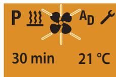
Indicazione nei riscaldatori ad aria in modalità di funzionamento continuo VENTILAZIONE
