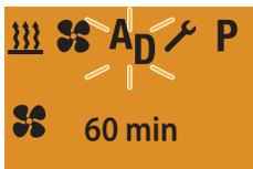
Indicazione nei riscaldatori ad aria in modalità di funzionamento continuo VENTILAZIONE (impostazione di fabbrica).
