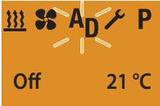
Dopo l'indicazione APPARECCHIO SUPPLEMENTARE OFF viene visualizzata la videata iniziale. In Illuminazione veicolo OFF dopo 10 secondi si spegne l'illuminazione del display.
